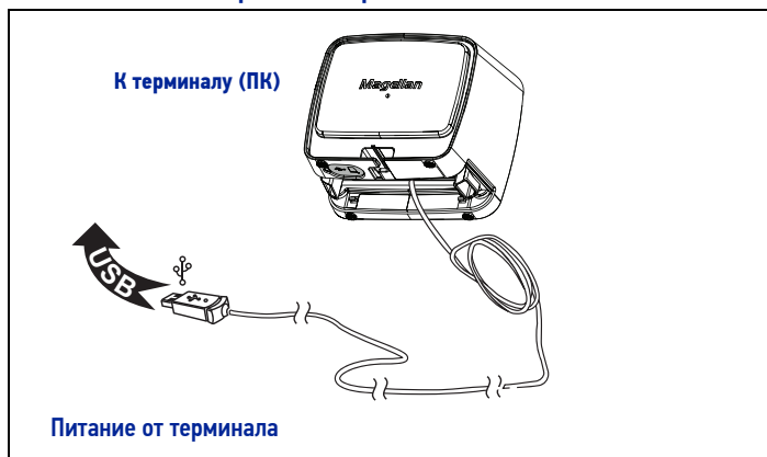
Рис. 6. Питание от терминала через кабель USB типа A
