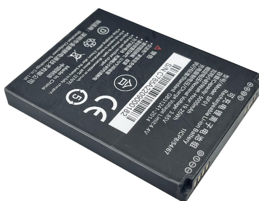
Аккумулятор P/N: CHA-BTRY-T3 Pro-5000MA 5000 мАч, 3.85 В.
